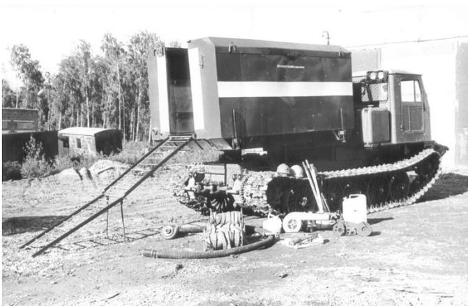
Рис. 2- Модуль МЛ-4 на трелёвочном тракторе ТТ-4
