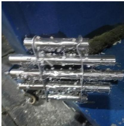
Рис.4. Магнитная решетка после эксплуатационного периода
