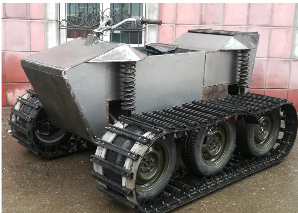
Рисунок 5 – Прототип малогабаритного гусеничного транспортера [6,7]
