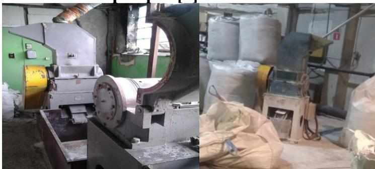
Рис.1. Измельчитель пластмасс ИРП-300
