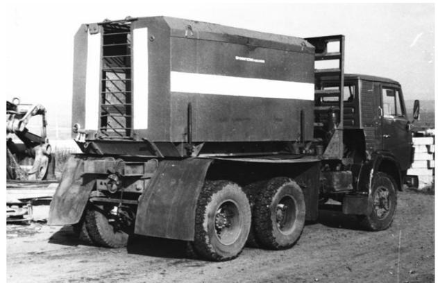
Рис. 3- Модуль МЛ-4 на лесовозном автомобиле КамАЗ
