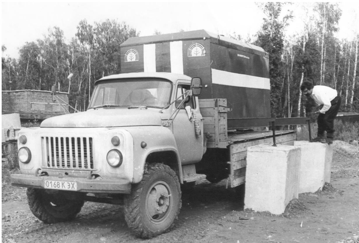
Рис. 1- Установка модуля в кузов автомобиля ГАЗ-53 (фото автора)
