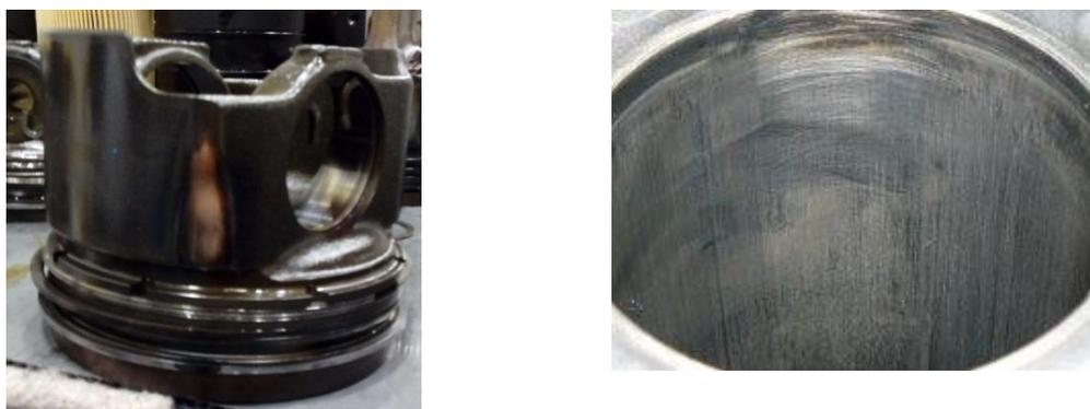
Рис. 2 – Поршень и гильза цилиндров двигателя с натирсами после эксплуатации
