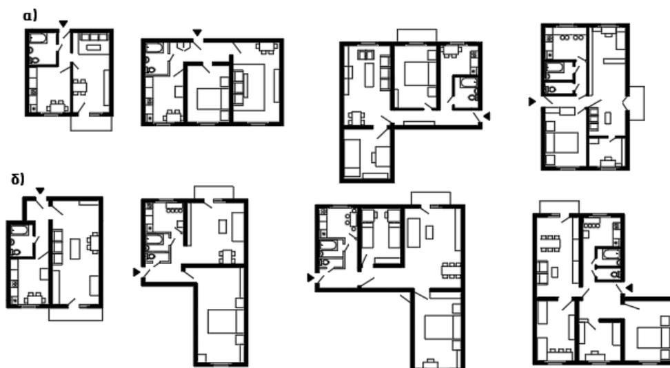
Рис. 2 - Типы квартир крупнопанельных серий второго поколения:
