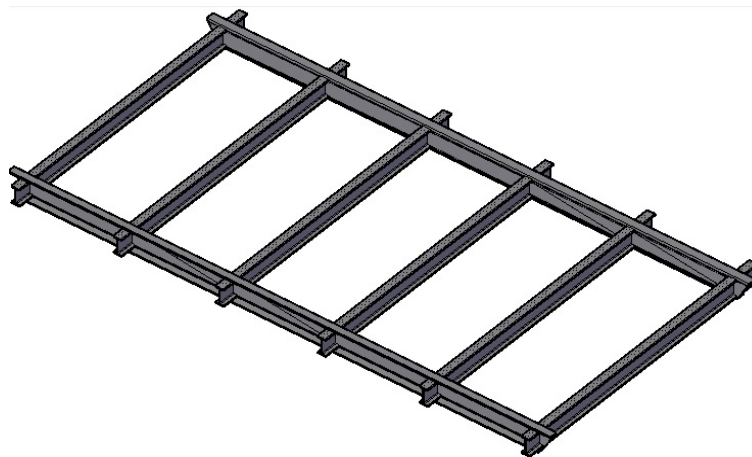
Рис. 1. Установка продольны балок на площадке
