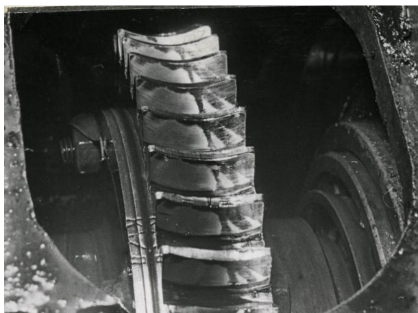
Рис. 1. Пятно контакта после 34 часов приработки
