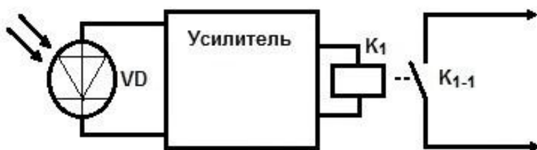
Рис. 1. Принципиальная схема работы датчика освещенности
