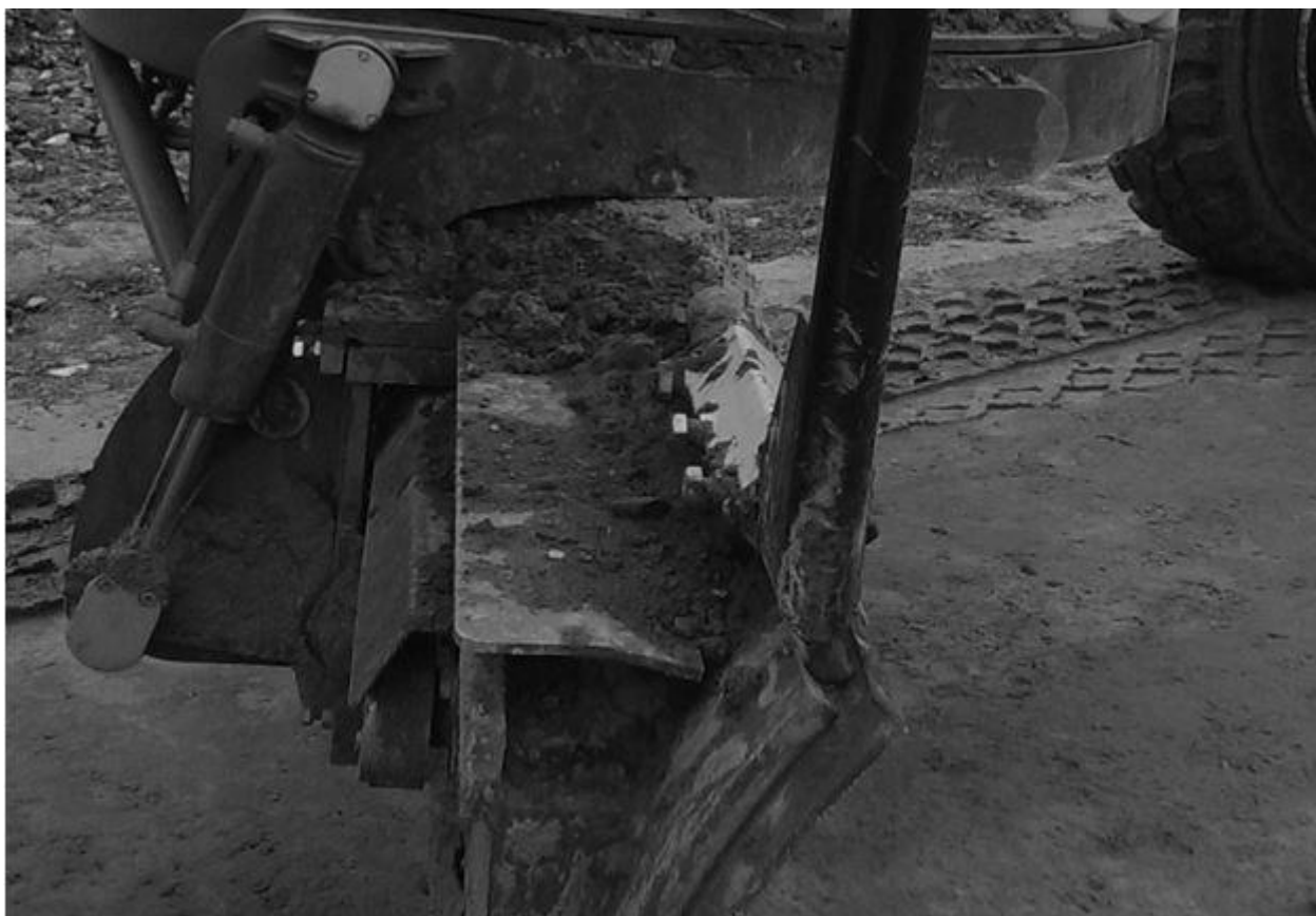
Рис.2 – Крепление виброустойчивой мачты к отвалу автогрейдера
