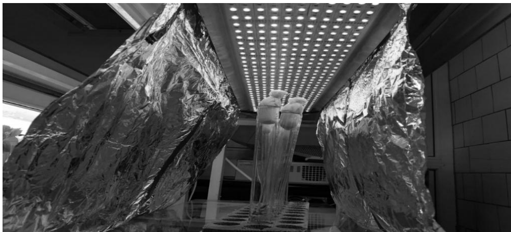
Рис. 11. LED фитоустановка с отражающими экранами в рабочем режиме
