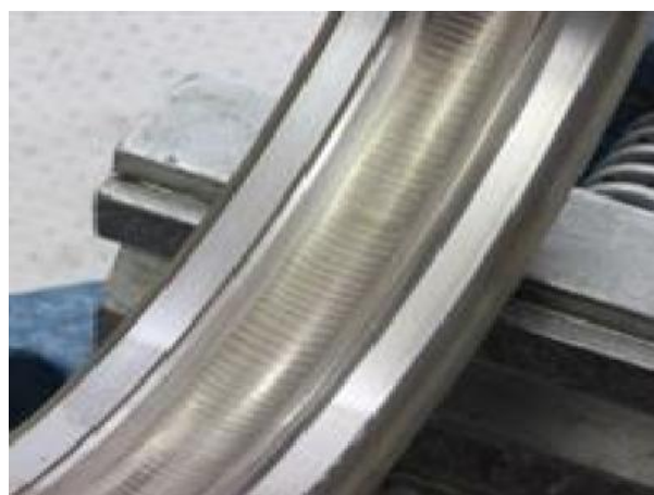
Рис. 1.2. Вид подшипника АТЭД электропоезда «Ласточка» и его повреждений от протекания электрического тока.
