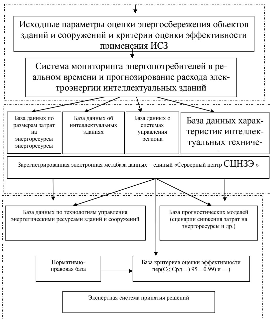
Рисунок 2. Структурно-функциональная схема автоматизированной информационной базы данных СЦНЗЭ.
