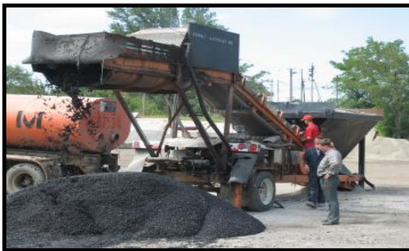
Рис.3 Мобильная установка «Муха» для приготовления асфальтобетонной холодной смеси из гранулята
