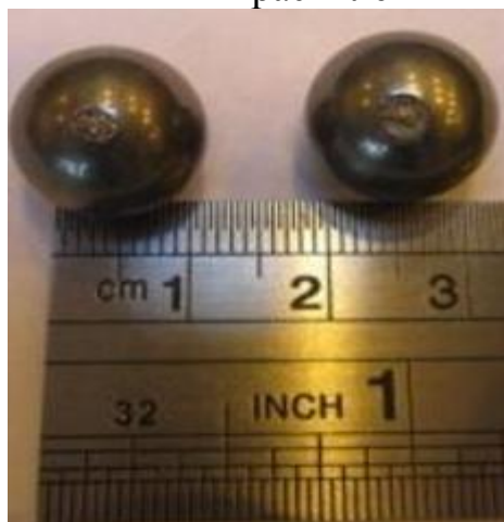
Рис. 1.1. Вид подшипника АТЭД электропоезда «Ласточка» и его повреждений от протекания электрического тока. распиленный шариковый подшипник АТЭД
