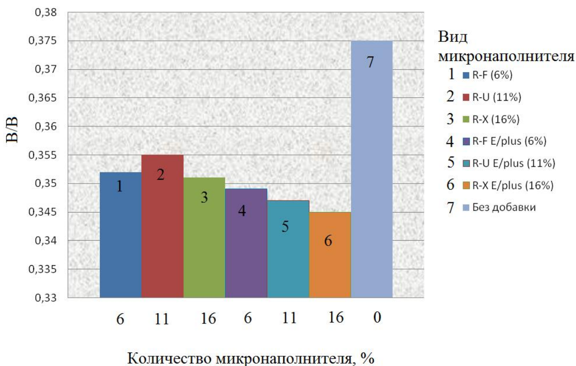
Рис.2. Влияние микронаполнителя на В/Вяз при равной подвижности смеси.
