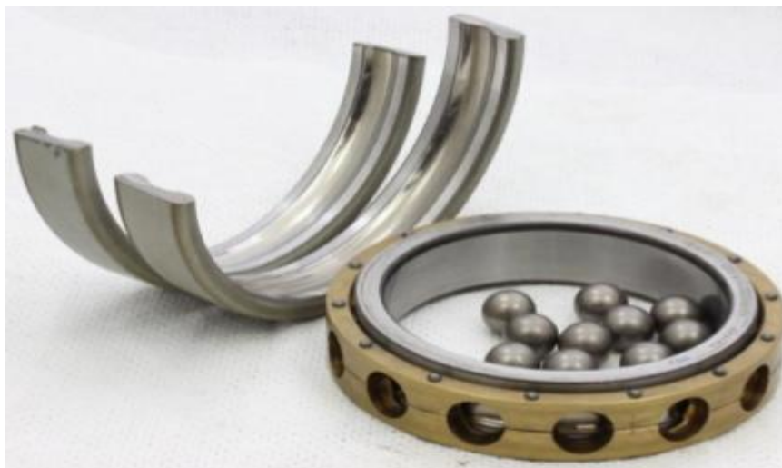
Рис. 1.1. Вид подшипника АТЭД электропоезда «Ласточка» и его повреждений от протекания электрического тока. распиленный шариковый подшипник АТЭД
