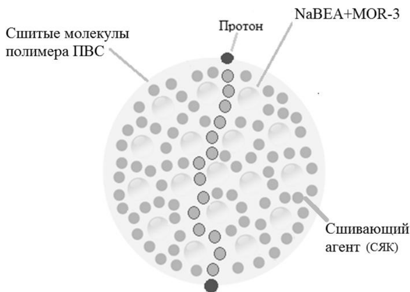
Рис. 3. Схема переноса протонов через структуру композита
