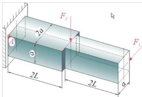
2 Выполняя геометрические и прочностные расчеты компонентов колесных и гусеничных машин, решите задачу (ОПК-4.2). Используя созданную в предыдущем задании трехмерную модель изделия, определите для него массу, центр масс и главные моменты инерции.
