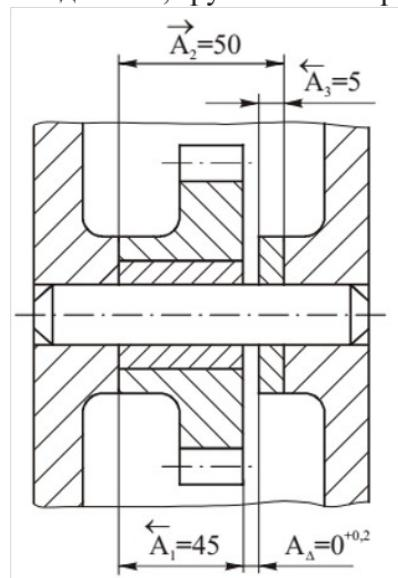
11. С учетом стандартов, норм и правил в профессиональной деятельности при сборке методом регулирования, в качестве компенсатора принять звено  $A_3$ . Размеры составляющих звеньев:  $A_1 = 45 \text{ мм.}$ ,  $A_2 = 70 \text{ мм.}$ ,  $A_3 = 25$ ,  $A_\Delta = 0^{+0,2} \text{ мм.}$
