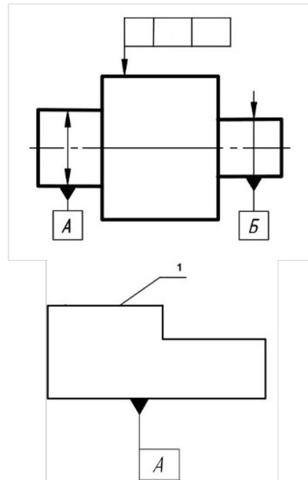
7. С учетом стандартов, норм и правил в профессиональной деятельности нанести на чертеж детали следующие технические требования: допуск параллельности поверхности 1 относительно плоскости А 0,01 мм.; допуск плоскостности поверхности 1 – 0,06 мм
