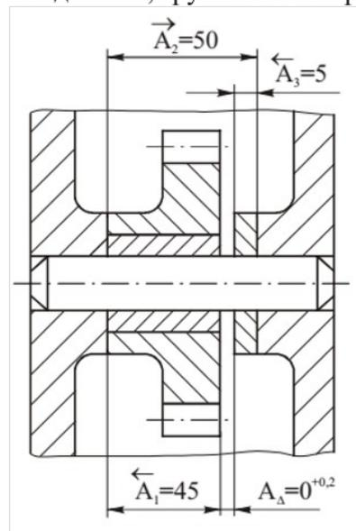
11. С учетом стандартов, норм и правил в профессиональной деятельности при сборке методом регулирования, в качестве компенсатора принять звено  $A_3$ . Размеры составляющих звеньев:  $A_1 = 45 \text{ мм}$ .,  $A_2 = 70 \text{ мм}$ .,  $A_3 = 25$ ,  $A_\Delta = 0^{+0.2} \text{ мм}$ .
