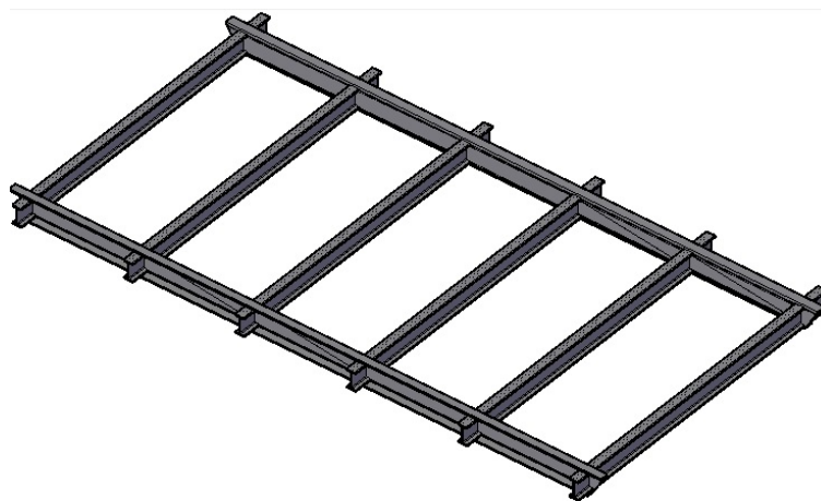
Рис. 1. Установка продольных балок на площадке
