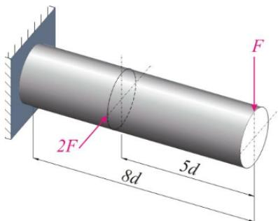
2 Выполняя геометрические и прочностные расчеты компонентов колесных и гусеничных машин, решите задачу (ПК-4.2). Используя созданную трехмерную модель изделия, определите для него массу, центр масс и главные моменты инерции.
